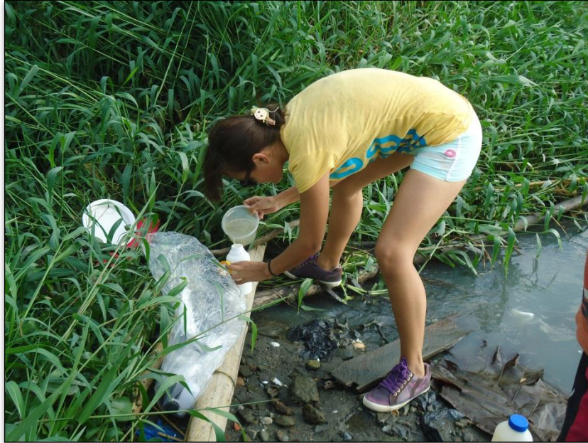
Fotografía 20: Toma de muestra agua residual
