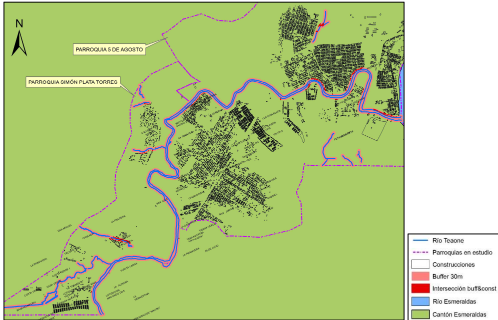
Ilustración 29. Zonas vulnerables a inundaciones Se pueden notar varias zonas marcadas en color rojo que representan una intersección entre construcciones y la zona de influencia de 30 metros del río Teaone.
