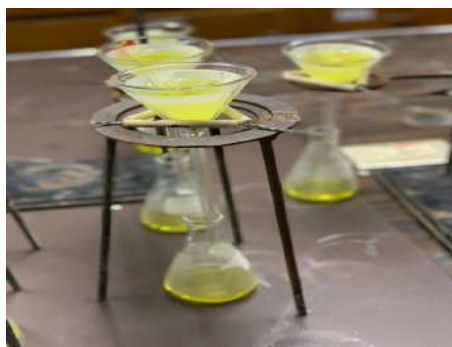
Figura 30. Análisis gravimétrico para la determinación de sílice
