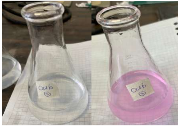
Figura 34. Análisis volumétrico para la determinación de bicarbonatos
