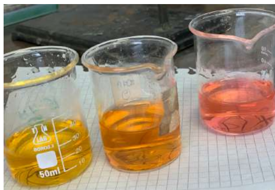
Figura 33. Análisis volumétrico para la determinación de carbonatos
