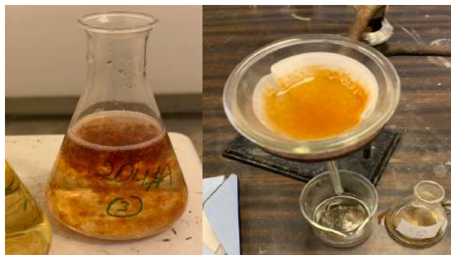
Figura 35. Análisis gravimétrico para la determinación de óxido de hierro
