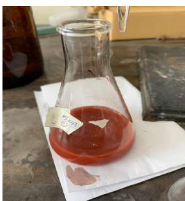
Figura 32. Análisis volumétrico para la determinación de cloruros
