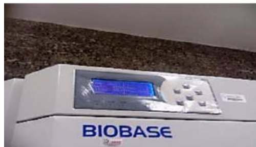
Figura 2. Panel de control de la cámara de simulación climática
