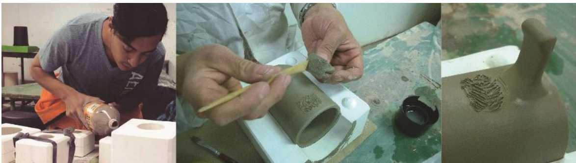
Imagen 98: Colado de barbotina y cosido de partes
