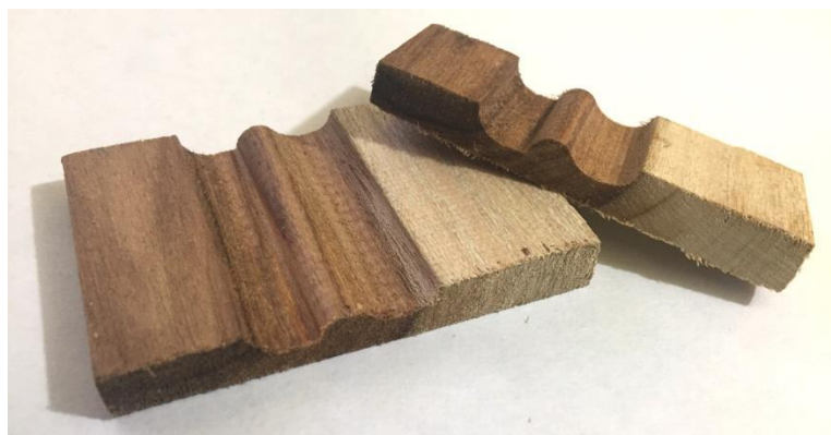
Imagen 102: Corte de maderas con CNC
