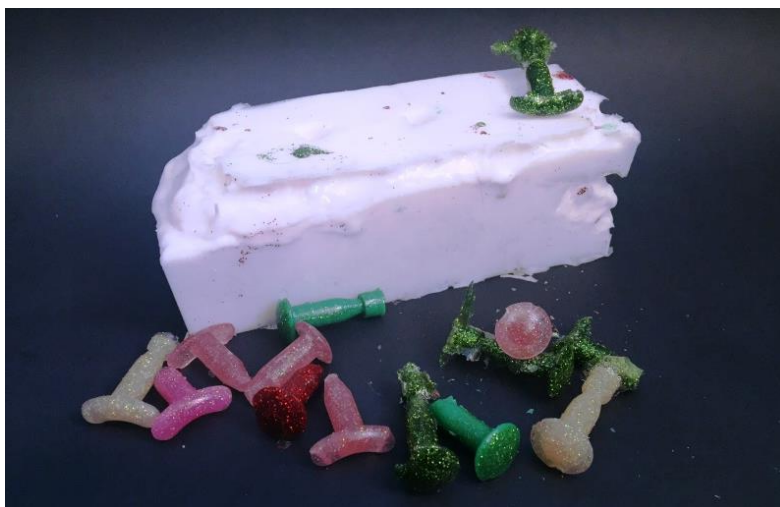
Imagen 105: Molde de caucho silicón y piezas de resina ( iD Card #31: appearance prototype )
