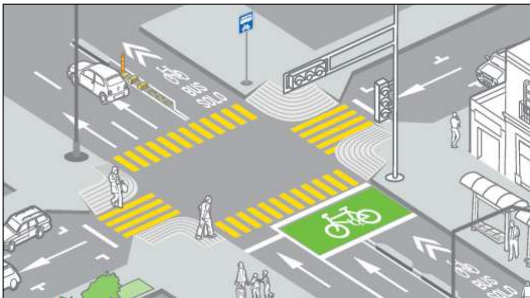
Figura4. 10 Demarcación de una intersección con paso peatonal
