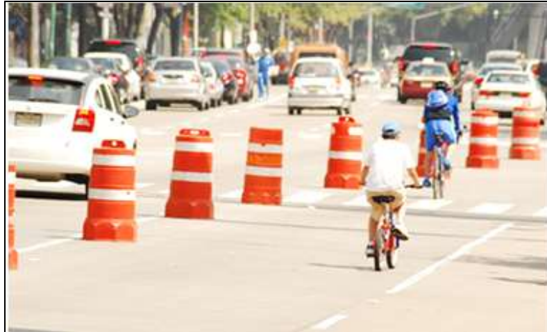
Figura5. 11 Barrera plástica de contención.
