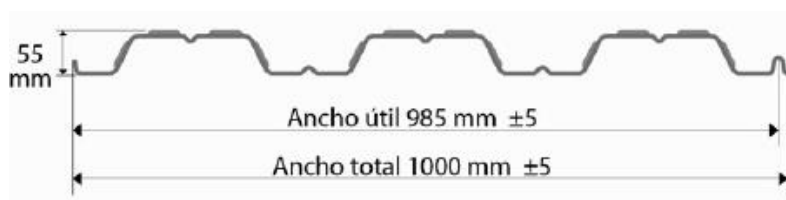
Ilustración 4. Perfil placa colaborante
