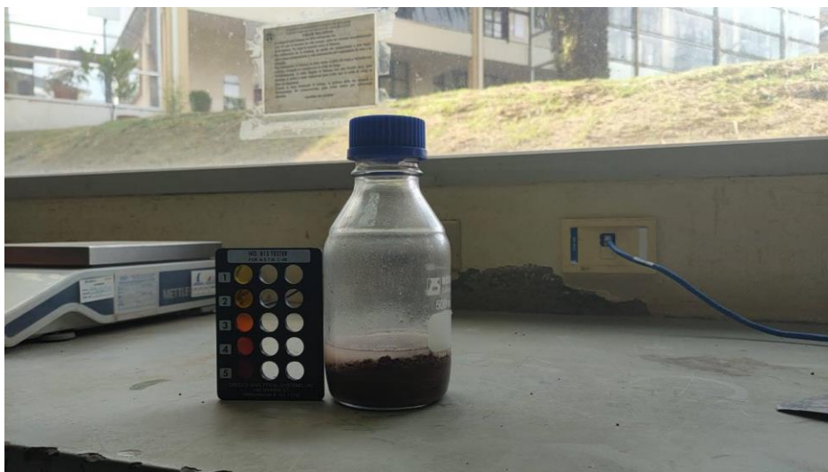
Figura 3.3. Ensayo de contenido orgánico
