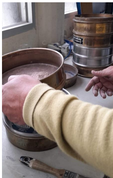
Figura 3.1. Ensayo de granulometría agregado fino
