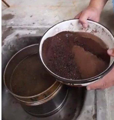
Figura 3.7. Ensayo del porcentaje de material fino que pasa el tamiz #200
