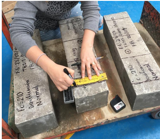
Figura 3.15. Muestras para el ensayo de flexión de f'c=210 Kg/cm 2 a los 28 días
