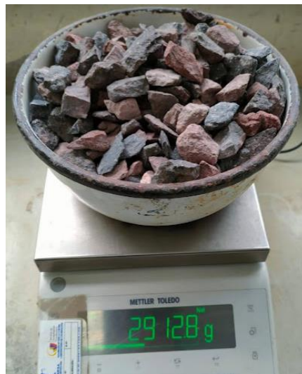
Figura 3.12. Resultado del peso seco de la muestra para el ensayo de gravedad específica del agregado grueso
