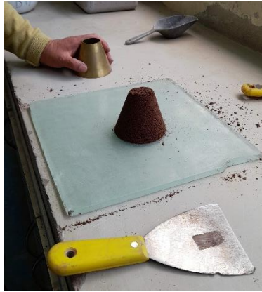
Figura 3.4. Ensayo de gravedad específica del agregado fino
