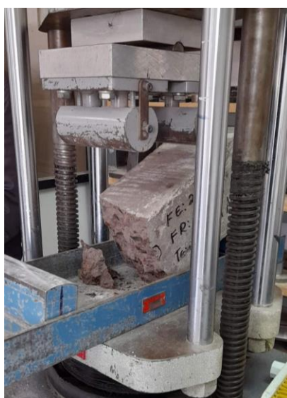
Figura 3.16. Rotura de la vigueta en la prensa de ensayo.
