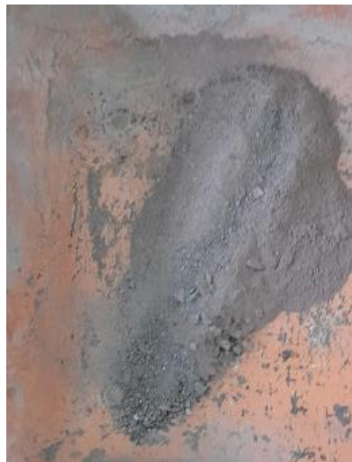
Figura 3.11. Muestra obtenida después del ensayo de abrasión en la máquina de Los Ángeles
