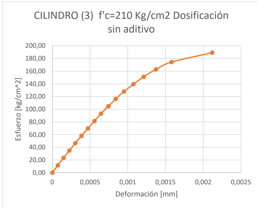
Figura 3.19. Gráfica esfuerzo - deformación cilindro (3) f'c = 210 \text{ Kg/cm}^2 de hormigón sin aditivo
