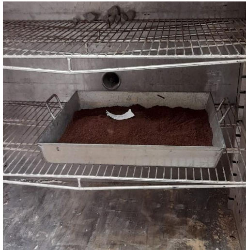
Figura 3.6. Ensayo de contenido de humedad del agregado fino
