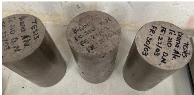
Figura 3.13. Muestras para el ensayo de compresión de f'c=210 \text{ Kg/cm}^2 a los 7 días
