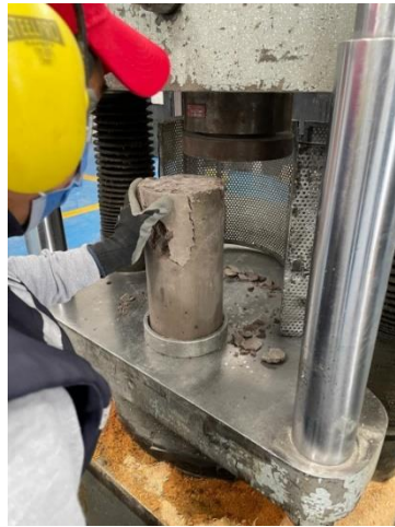
Figura 3.14. Rotura del cilindro en la prensa de ensayo.
