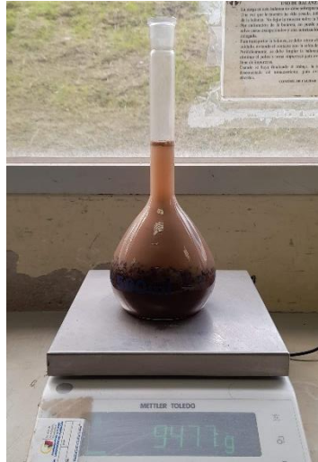
Figura 3.5. Colocación del material en el matraz para ensayo
