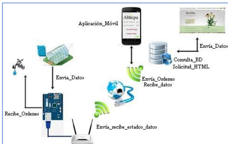
Figura 1-14. Topología general de una Red IoT aplicada al monitoreo de efectos ambientales en la agricultura.(Ramírez & Mazón, 2018)
