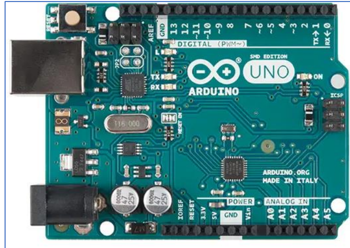
Figura 3-02. Tarjeta de desarrollo Arduino UNO (Arduino, 2020).
