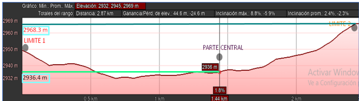
Figura 3-06. Perfil de elevación que corresponde a la zona de análisis del sistema diseñado. (Google Earth, 2022).
