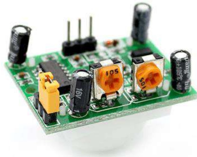
Figura 10. Vista Interna del Sensor de Movimiento PIR
