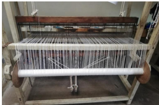
Figura 17: Telar manual armado, con urdimbre y adecuado a las dimensiones necesitadas. (2020)
