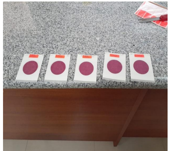
Figura 25. Análisis de Coliformes fecales en el laboratorio de Microbiología.
