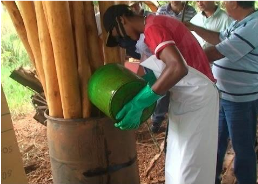
Ilustración 2.37 Elementos de madera sumergidos en diesel (Calameo, 2010)
