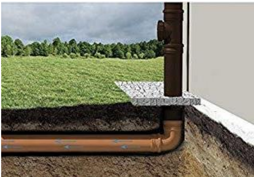
Ilustración 4.5 Bajante de aguas lluvia enterrado (Alcupi, 2015)
