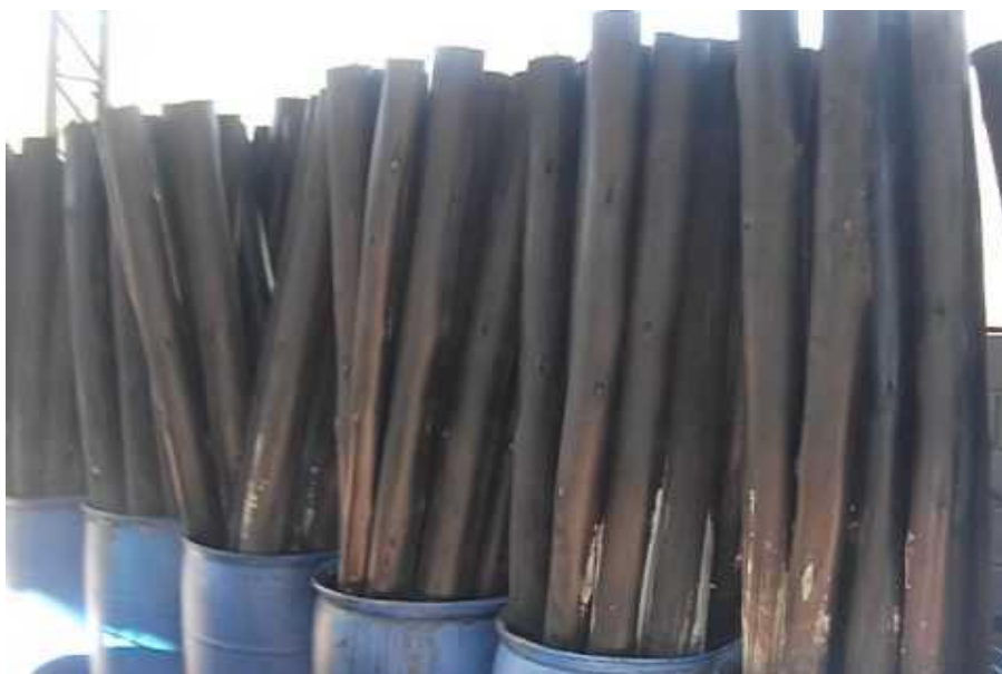
Ilustración 2.36 Elementos de madera sumergidos en alquitrán (Scribd, 2016)
