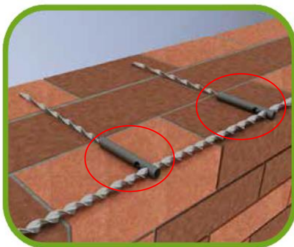
Ilustración 2.22 Conectores de acero en un muro de ladrillos (Kerakoll, 2015)
