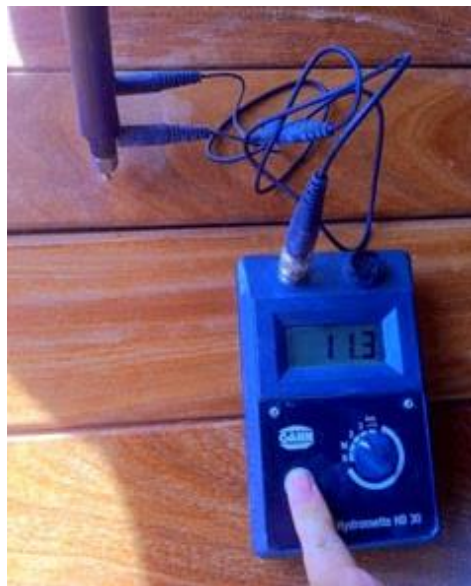
Ilustración 2.55 Medición de la humedad de un piso de madera con un higrómetro (Centro de Transferencia Tecnológica de la Madera de Chile, 2006)
