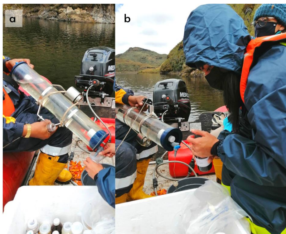
Figura 4. Muestreo estratificado de la columna de agua mediante botella Van Dorn de 2,2 L. a, Instrumento para la obtención de muestras de agua a diferentes profundidades; b, Colocación de muestra de agua en botellas ámbar después de la colecta.
