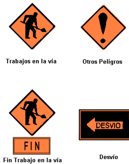
Imagen 5.5. Trabajos en la vía.
