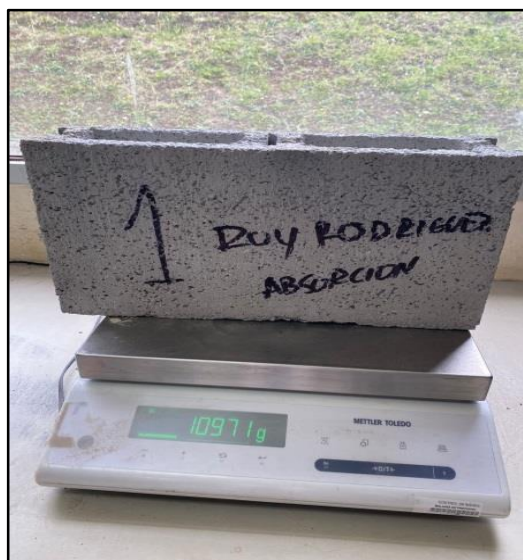
Anexo 12. Resistencia a la Absorción de Agua de los Mampuestos tipo Bloque.
