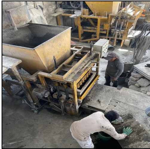
Anexo 4. Preparación de los Mampuestos Tradicionales tipo Bloque.
