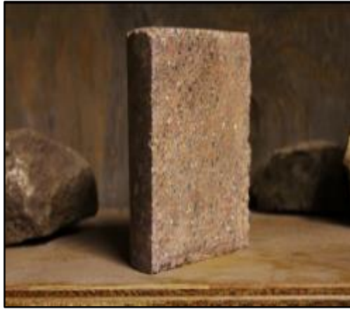
Figura 23. Mampuesto Ecológico Geopolimerizado, (Zhang,2013).
