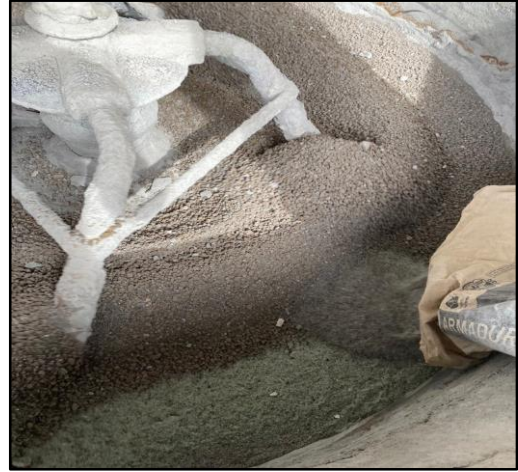
Anexo 9. Vertido y Mezclado de Materiales para la Fabricación de los Mampuestos Ecológicos tipo Bloque.
