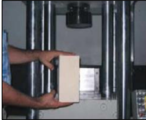
Figura 21. Mampuesto Ecológico Cementado, (Zhang,2013).
