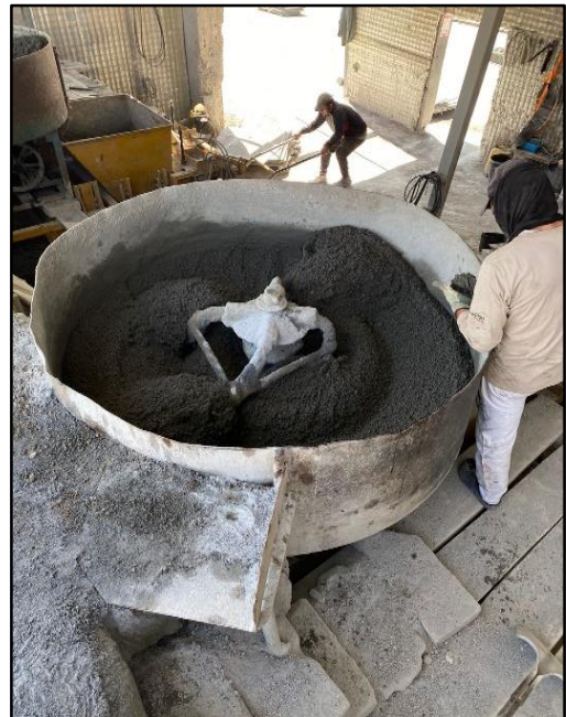
Anexo 2. Mezclado de Materiales para la Fabricación de los Mampuestos Tradicionales tipo Bloque.
