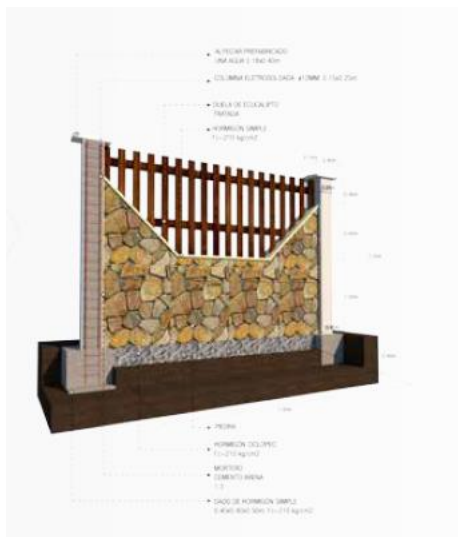
Figura24: Cerramiento con mampostería de piedra y madera.
