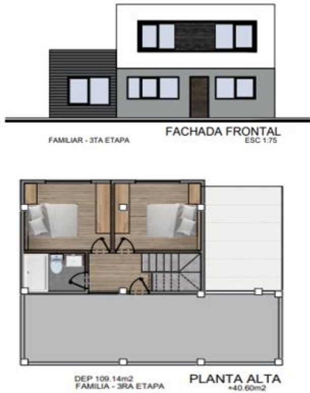
Figura 18: Fachada frontal y distribución de vivienda progresiva 3RA etapa. Fuente: Arq. Evelyn Mármol.
