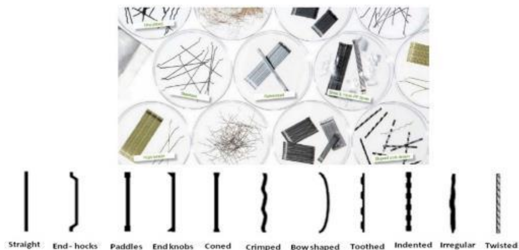
Ilustración 33: Diferentes tipos y formas de fibras de acero, (Bekaert (mencionado en Orbe et al., 2015)).
