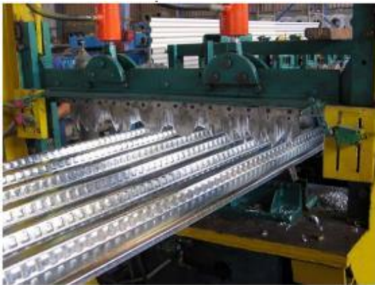
Ilustración 10: Doblado y cortado de placas colaborantes (Sencico, s.f., pág. 9)
