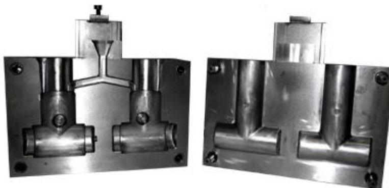
Figura 10: Molde o coquilla para fundición
