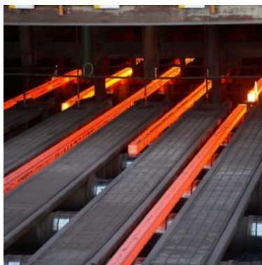
Figura 9: Colada Continua de palanquillas
