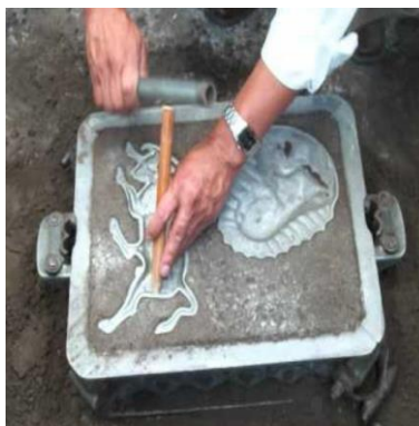
Figura 11: Molde de arena
