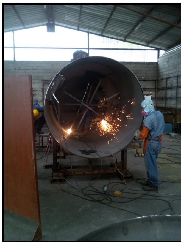
Figura Nro. 9. Esmerilado de Recipientes a presión
