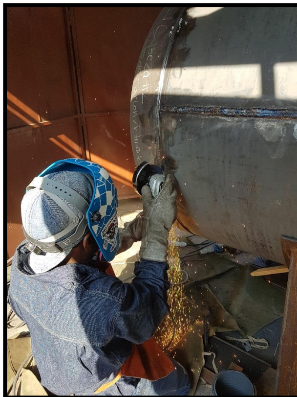
Figura Nro. 8. Esmerilado de Equipos a presión
