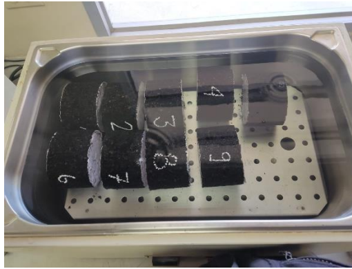
Ilustración 15: briquetas en baño maría
