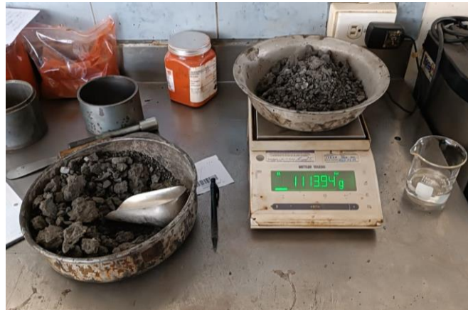
Ilustración 16: Elaboración de briquetas
