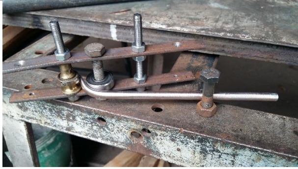
Curvado de inyectores para tapas
