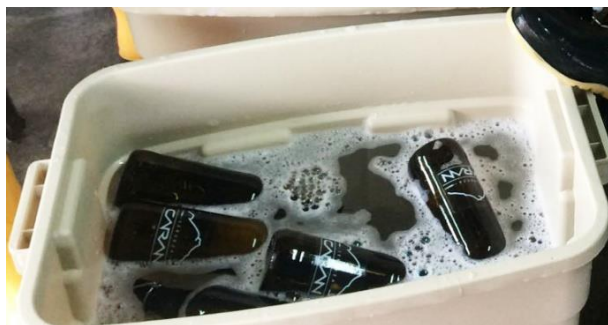
Figura 9. Inmersión de botellas en agua caliente. AS-IS.
