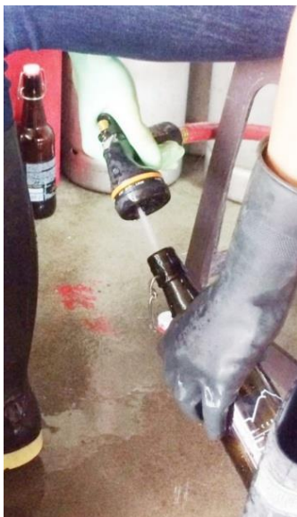
Figura 11. Enjague a presión con agua potable, AS-IS.
