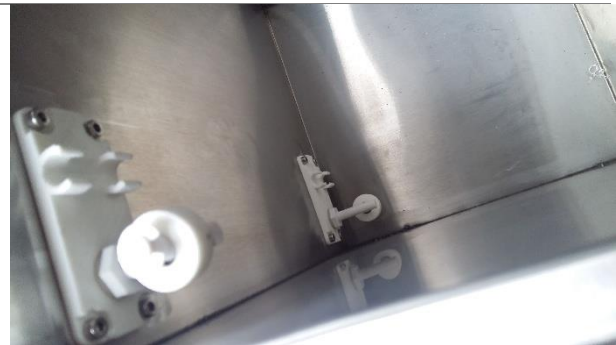
Sensores de control, nivel de liquido
