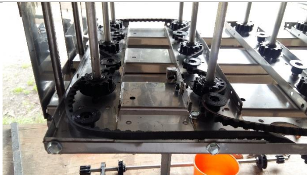
Colocación de banda de transmisión
