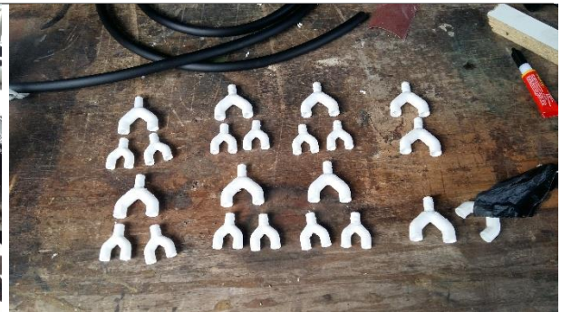
Derivadores superiores de agua
