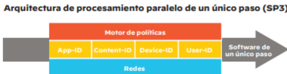
Figura 1-4 Arquitectura SP3 Fuente: (Palo Alto Networks, 2020b)
