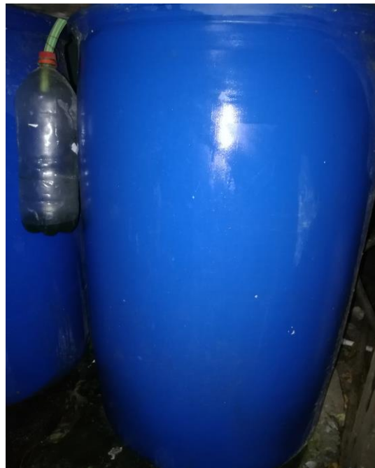
Figura 12 Tanque sellado y colocado la manguera para la emisión de gases durante el proceso de fermentación
