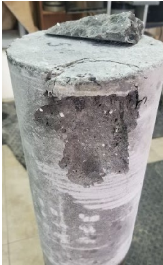
Falla en cilindro de hormigón con PVC
