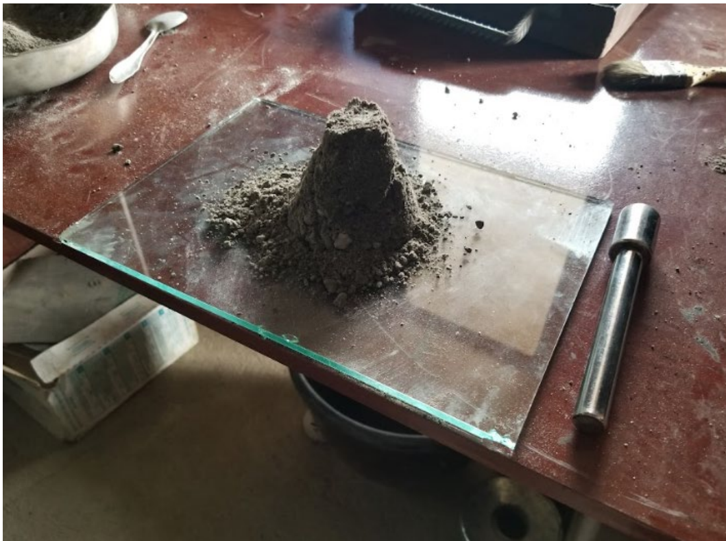
Caracterización de los agregados - Gravedad específica agregado fino
