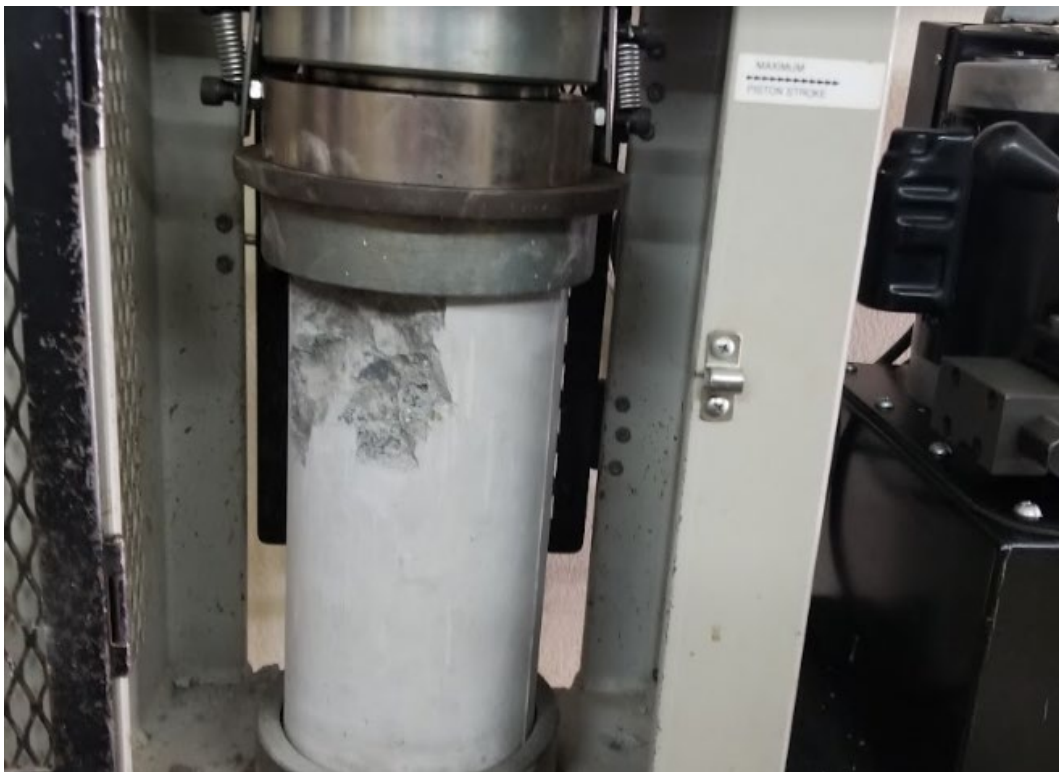
Falla en cilindro de hormigón
