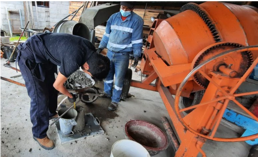
Medición de asentamiento
