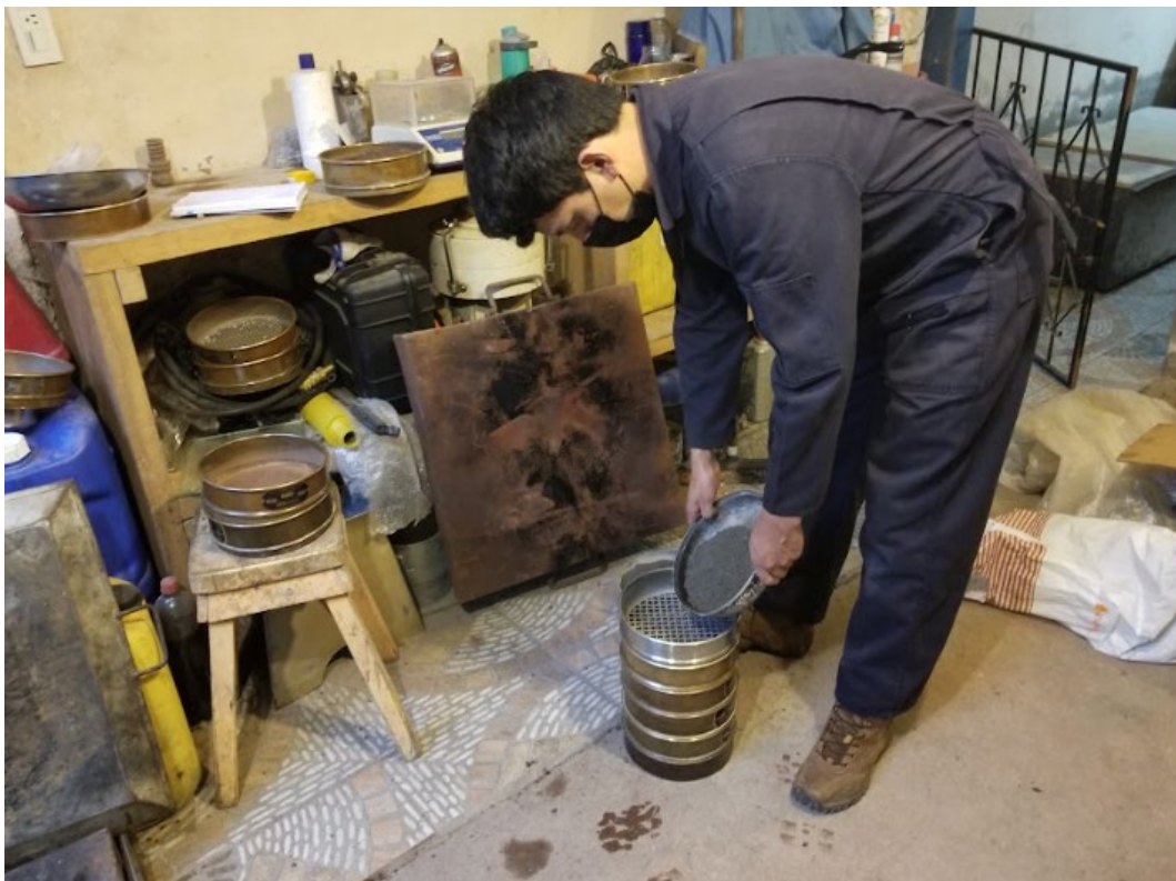
Caracterización de los agregados - Granulometría agregado fino
