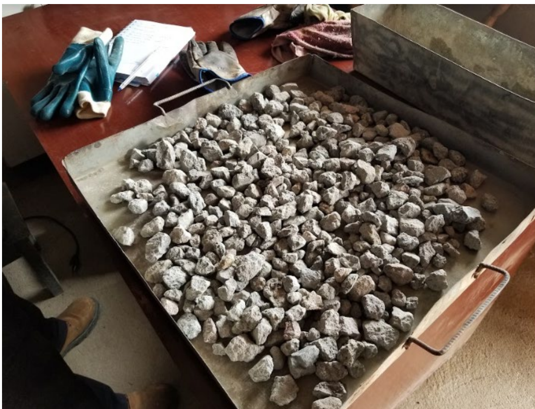
Caracterización de los agregados - Gravedad específica agregado grueso
