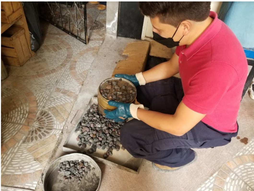
Caracterización de los agregados - Granulometría agregado grueso
