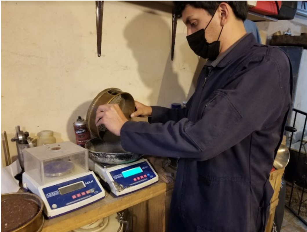
Caracterización de los agregados - Granulometría agregado fino
