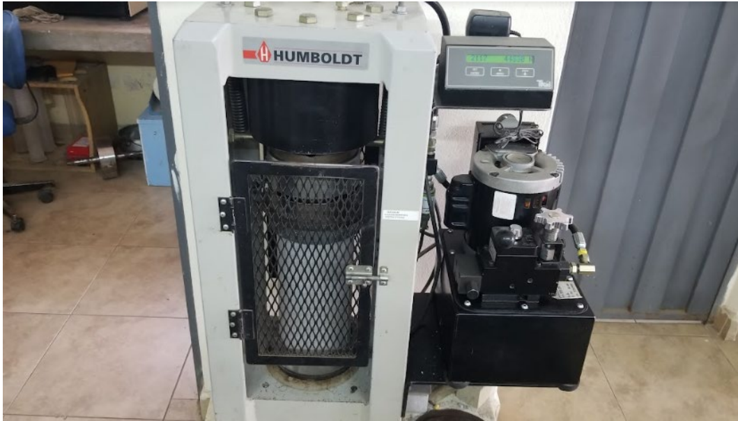
Ensayos a compresión de cilindros
