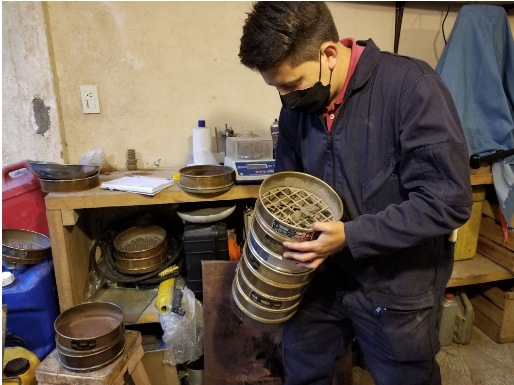
Caracterización de los agregados - Granulometría agregado grueso
