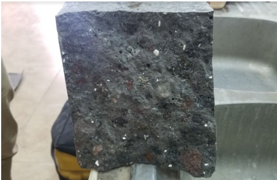
Falla en viga de hormigón con PVC
