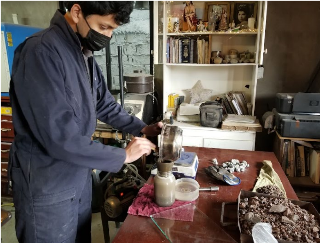
Caracterización de los agregados - Gravedad específica agregado fino
