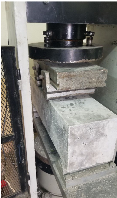
Ensayo a flexión de viguetas
