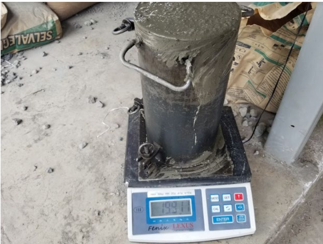
Toma de pesos del hormigón fresco
