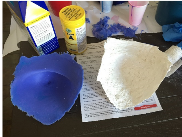
Figura 15. Molde de silicona y contramolde, (2020). Archivo personal.
