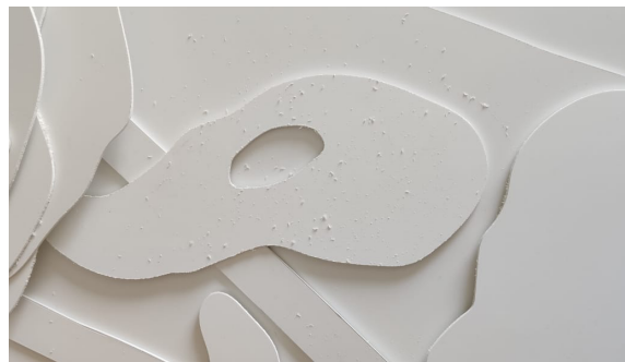
Figura 20. Corte de patrones con router cnc, (2020). Archivo personal.
