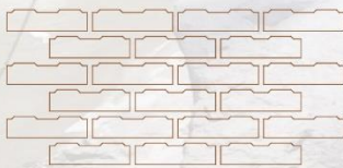
Forma de colocación de Adobe
