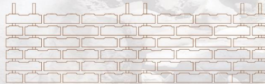
Forma de colocación de varillas
