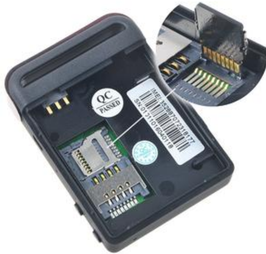
Figura 1-2 GPS Tracker TK-102 (vista interna)
