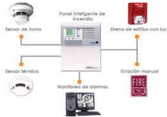
Gráfico 35. Sistema inteligente detección de incendio (SCI Seguridad Contra Incendios, 2016)
