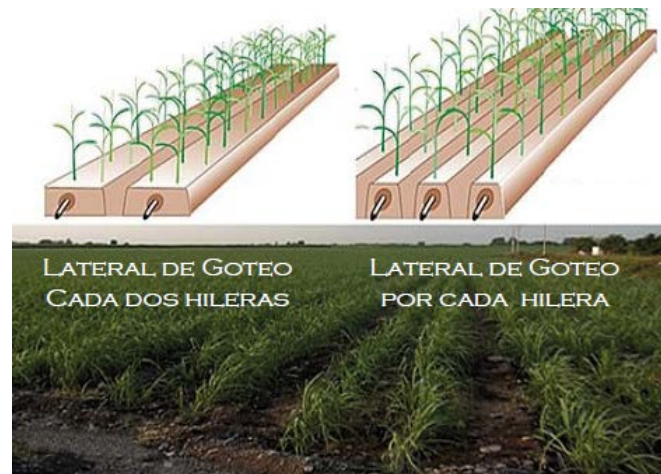
Ilustración 12: Riego Continuo de goteos de bajo flujo entre 1 l/h y 0.5 l/h
