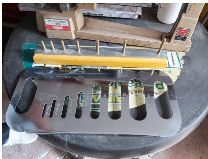
Ilustración 3.1: Aparato para la elaboración del ensayo de partículas tachas y alargadas.
