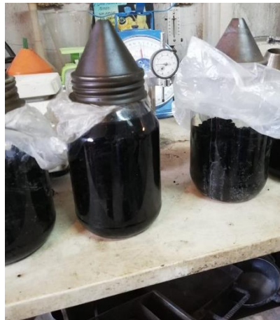
Ilustración 4.2: Muestras preparadas para el ensayo Rice
