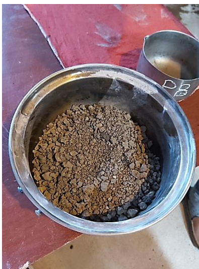
Ilustración 4.12: Escoria de alto horno usada en la mezcla asfáltica
