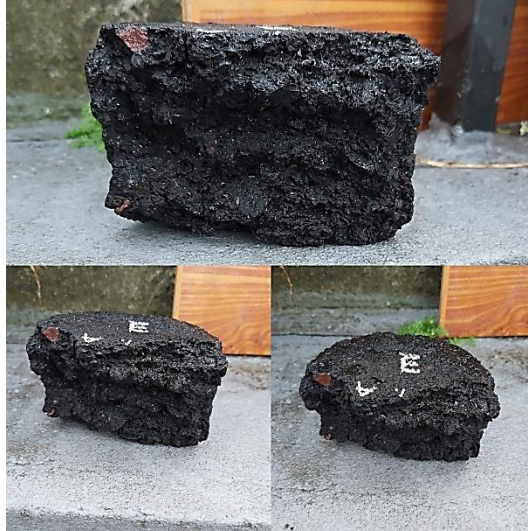
Ilustración 7.4: Briqueta de mezcla WMA más escoria expuesta al clima de Quito
