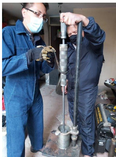
Ilustración 4.7: Compactación de la mezcla con el martillo Marshall
