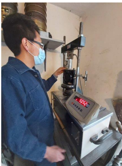
Ilustración 4.1: Ensayo de estabilidad y flujo Marshall
