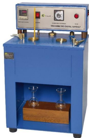
Ilustración 3.2: Equipo Saybolt para el ensayo de viscosidad
