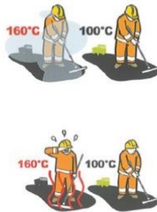
Ilustración 2.4: Reducción de las temperaturas de colocación y compactación
