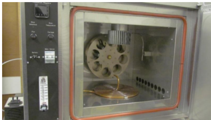
Ilustración 3.8: Horno de película delgada rodante
