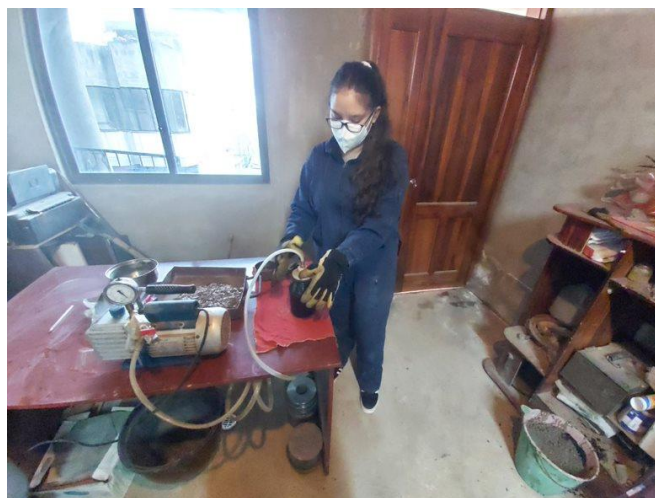
Ilustración 4.3: Eliminación de aire de las muestras para el ensayo Rice
