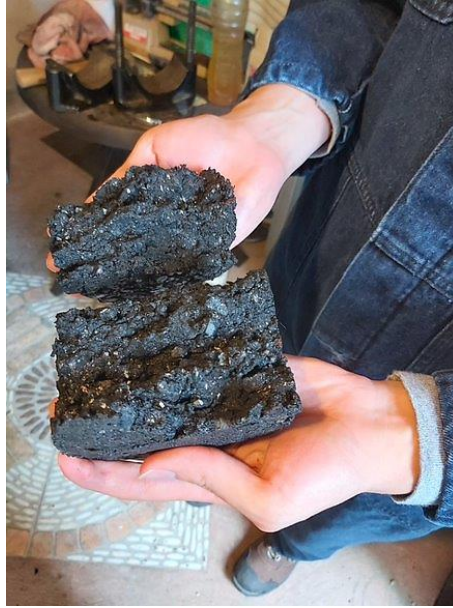
Ilustración 7.2: Briqueta WMA ensayada sin presencia de escoria
