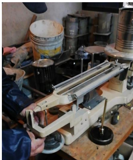
Ilustración 4.9: Determinación de la masa de Cemento Asfáltico
