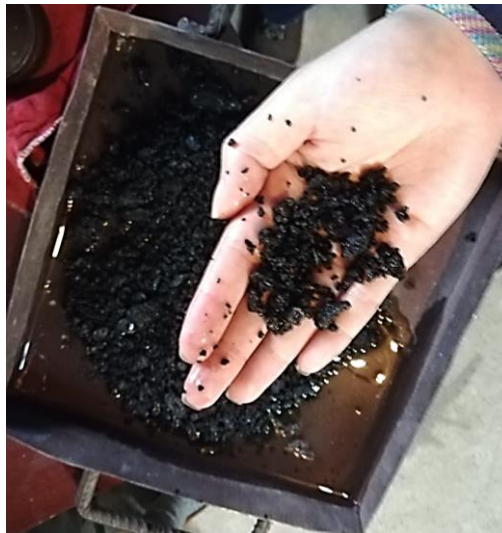
Ilustración 7.3: Verificación de Stripping
