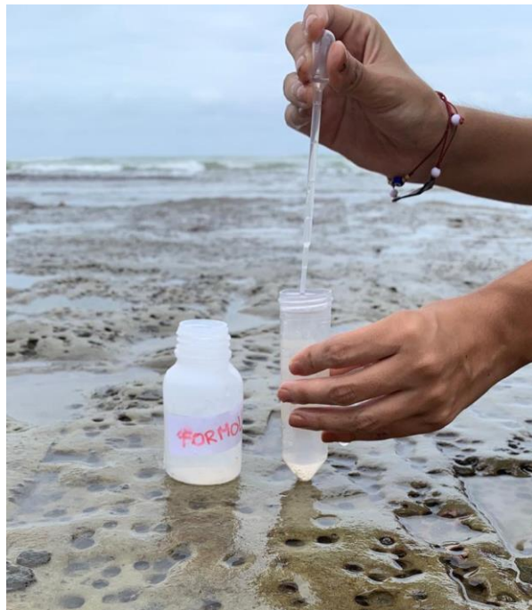
Ilustración 5 Fijación de las muestras con formol 3%
