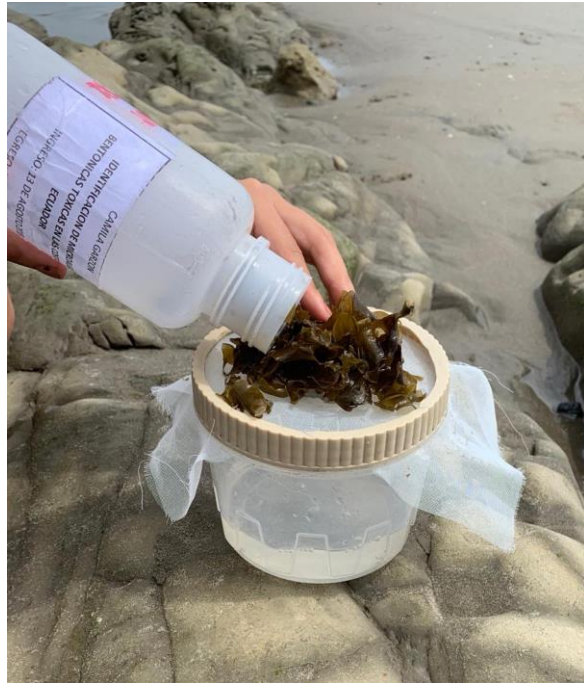
Ilustración 2 Filtración de agua de mar a través de un tamiz de 200 µm de poro para descartar partículas en suspensión.
