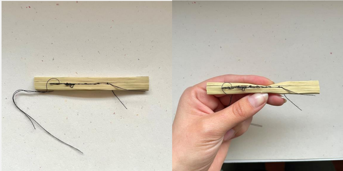
imagen 22: Costura en totora paralela a sus vetas, elaboración propia
