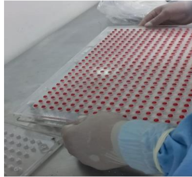
Figura 13. Encapsulado manual Fuente: Empresa (2022)
