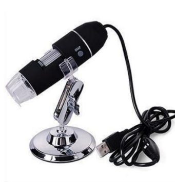
Figura 15. Mini microscopio portátil 1000x para la cuantificación de ninfas y huevos de ( Bactericera cockerelli ) en papa ( Solanum tuberosum ). Por el autor
