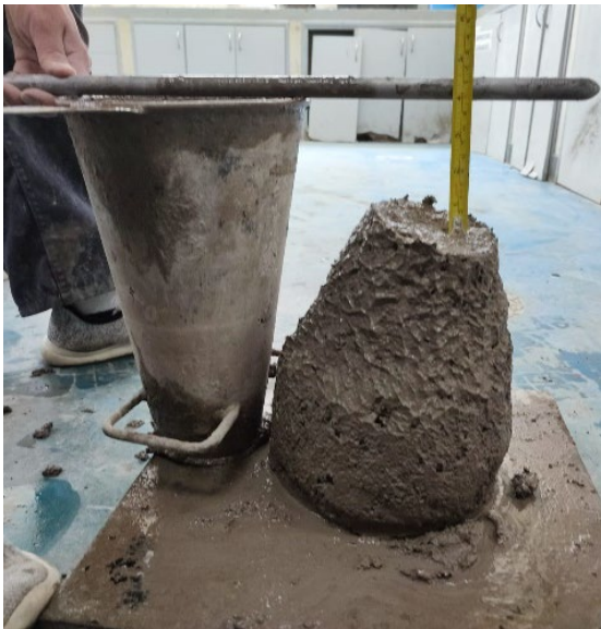
Anexo 8 Asentamiento Hormigón simple 280 Kg/cm 2 , PPL 0%
