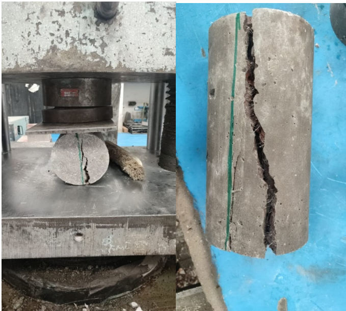
Anexo 13 Ensayo Brasilero, Hormigón simple 280 Kg/cm 2 , PPL 0.2%
