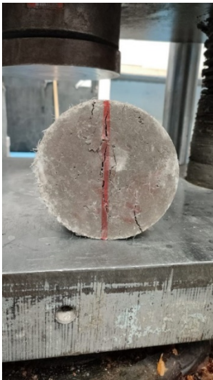
Anexo 15 Ensayo Brasilerero, Hormigón simple 280 Kg/cm 2 , PPL 0.5%
