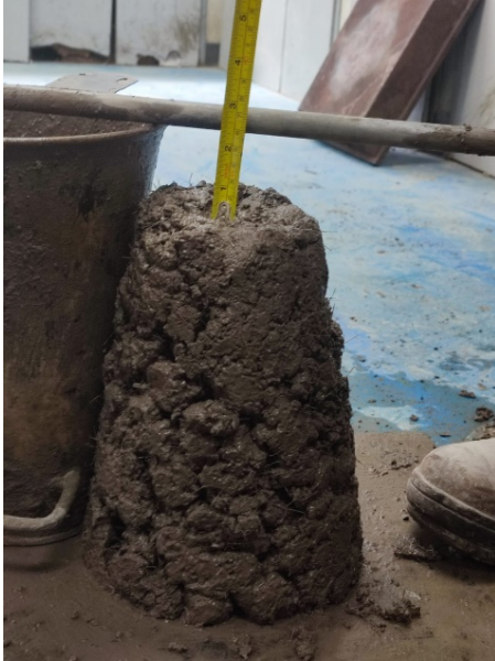
Anexo 9 Asentamiento Hormigón simple 280 Kg/cm 2 , PPL 0.2%
