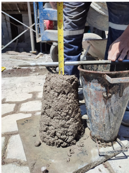
Anexo 6 Asentamiento Hormigón simple 240 Kg/cm 2 , PPL 0.3%
