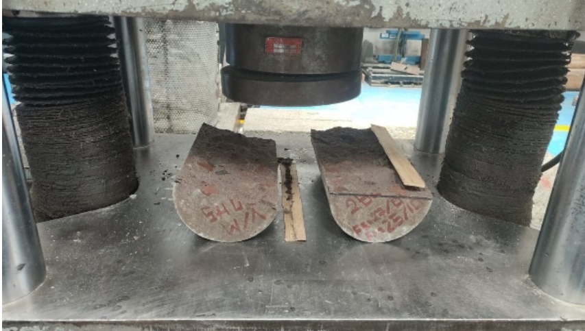
Anexo 12 Ensayo Brasilero, Hormigón simple 280 Kg/cm 2 , PPL 0%
