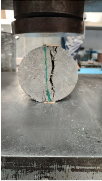
Anexo 14 Ensayo Brasilerero, Hormigón simple 280 Kg/cm 2 , PPL 0.3%
