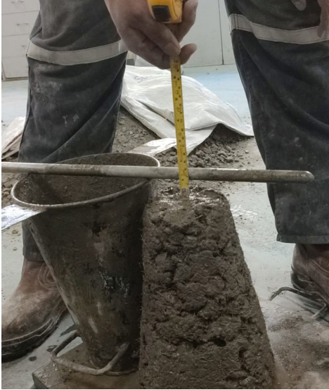
Anexo 11 Asentamiento Hormigón simple 280 Kg/cm 2 , PPL 0.5%
