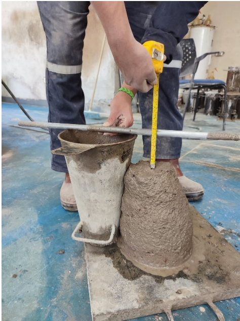
Anexo 4 Asentamiento Hormigón simple 240 Kg/cm 2 , PPL 0%
