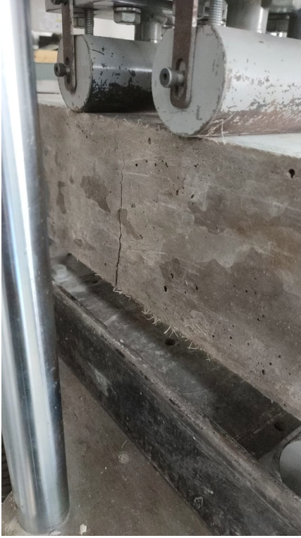
Anexo 18 Ensayo de flexión, Hormigón simple 280 Kg/cm 2 , PPL 0.5%
