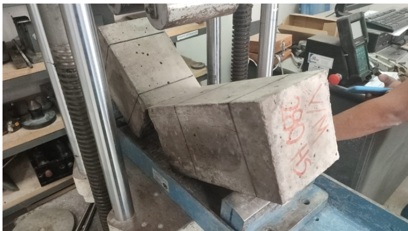
Anexo 16 Ensayo de flexión, Hormigón simple 280 Kg/cm 2 , PPL 0%
