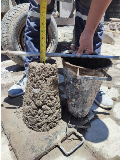
Anexo 7 Asentamiento Hormigón simple 240 Kg/cm 2 , PPL 0.5%
