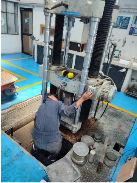
Anexo 3 Preparación ensayo de compresión
