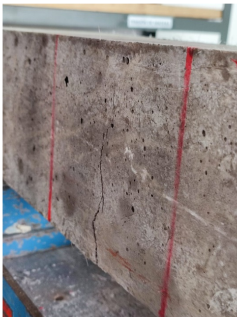
Anexo 17 Ensayo de flexión, Hormigón simple 280 Kg/cm 2 , PPL 0.3%
