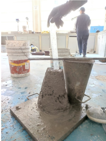
Anexo 5 Asentamiento Hormigón simple 240 Kg/cm 2 , PPL 0.2%
