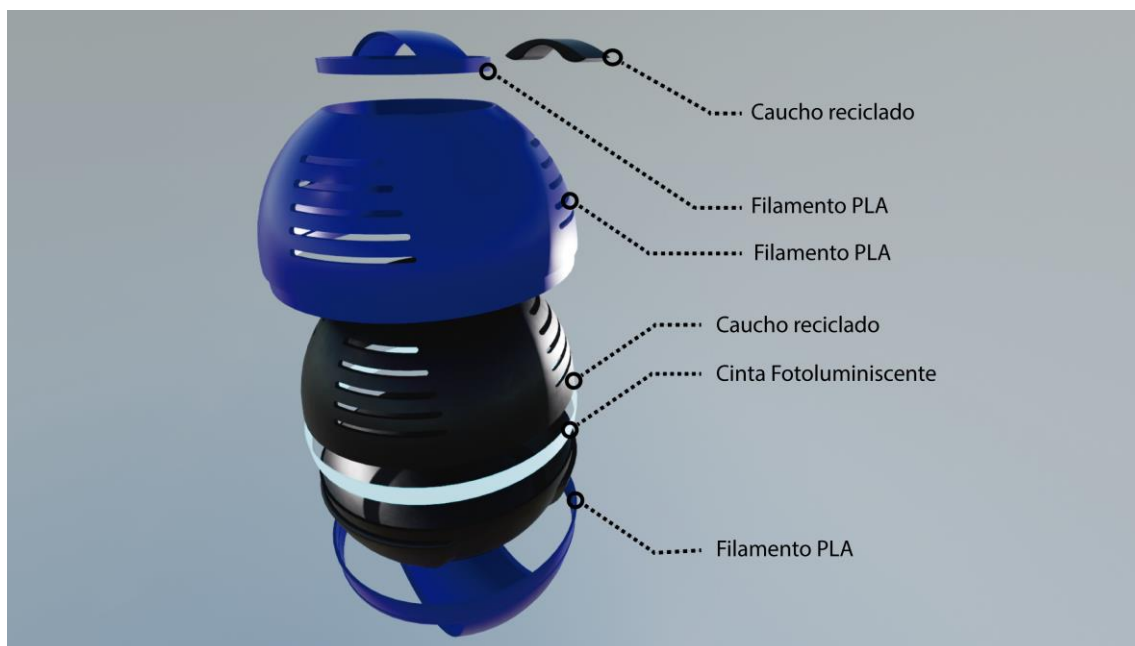
Figura 67. Despiece del contenedor, elaborado por el autor
