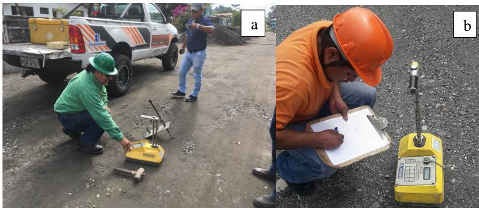
Figura 5a y 5b. Ensayos de contenido de humedad y densidad de suelos. (ECUASUELOS21, 2017)
