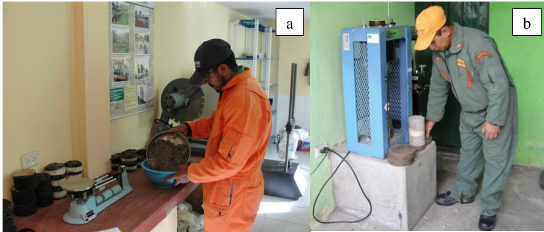
Figura 9a. Determinación de composición granulométrica mediante el uso de mallas y Figura 9b. Ensayo de compresión triaxial. (ECUASUELO21, 2017)
