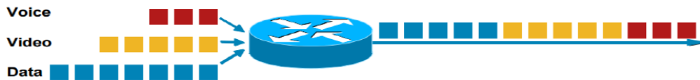
Figura 44. Manejo de colas con LLQ Obtenido de (Salazar, Comunicaciones Unificadas y VoIP - PUCE, 2019)
