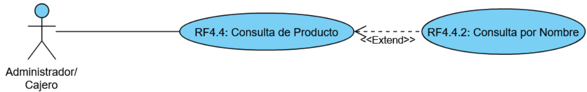
Diagrama de Caso de Uso A Detalle - Consulta de Producto por Nombre
