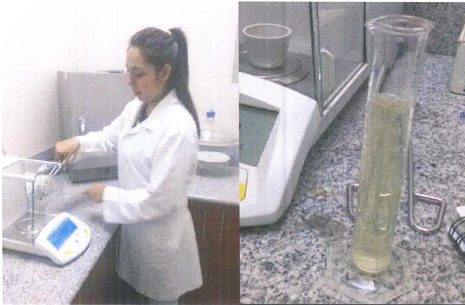
Figura 38 Calculando el peso de la cápsula con muestra de lodo
