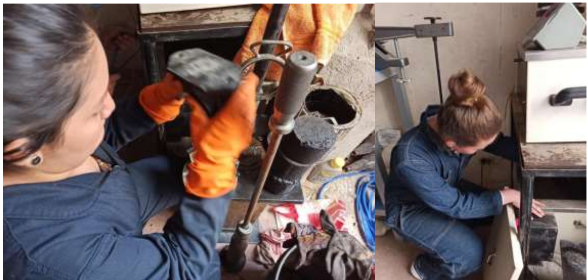
Anexo 28. Laboratorio Ensayos Marshall.
