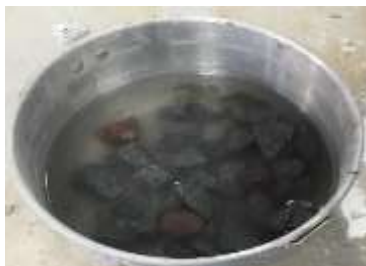
Ilustración 6. Ensayo Desgaste de los agregados por acción de sulfatos (L.D.M.S., 2019).
