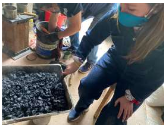
Ilustración 12. Mezclado con Aditivo para Briquetas.
