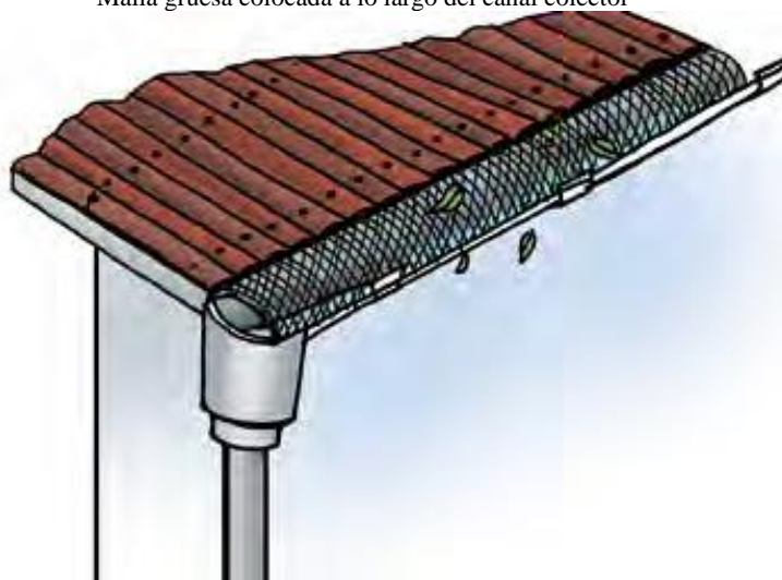
Figura 5: Canal recolector protegido con malla
