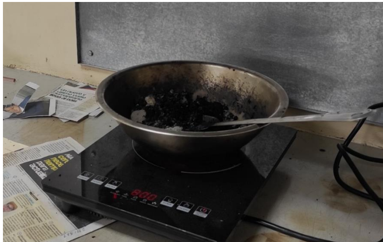
Ilustración 14: Preparación de asfalto para vigas
