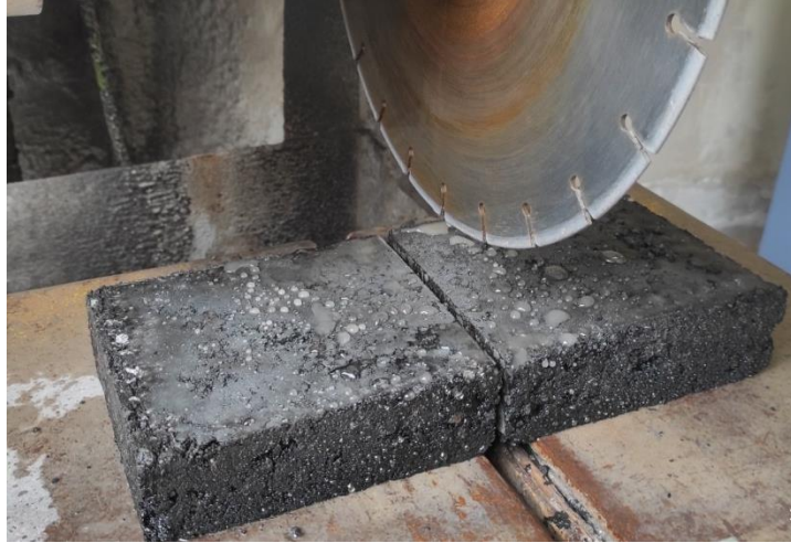
Ilustración 17: Elaboración de fisura de 5mm en capa antigua
