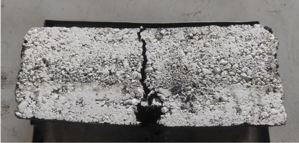
Ilustración 23: Deformación viga A1
