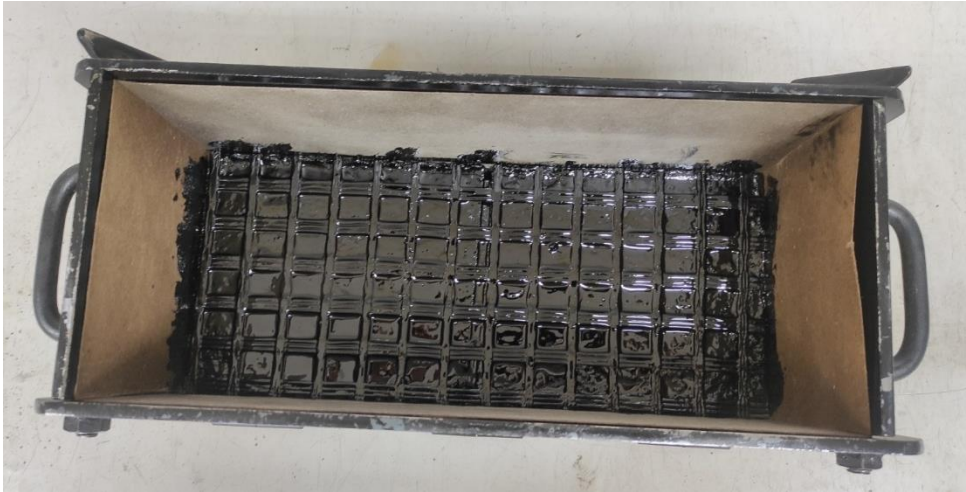
Ilustración 19: Capa antigua con riego de liga y geomalla
