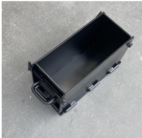
Ilustración 4: Molde real para mezclas asfálticas en caliente resístete a la energía de compactación.
