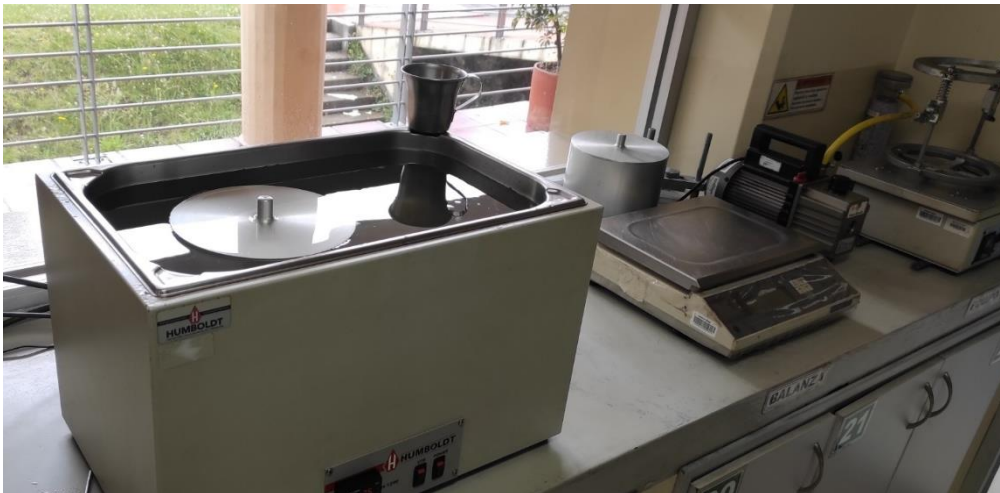
Ilustración 12: Ensayo de densidad máxima
