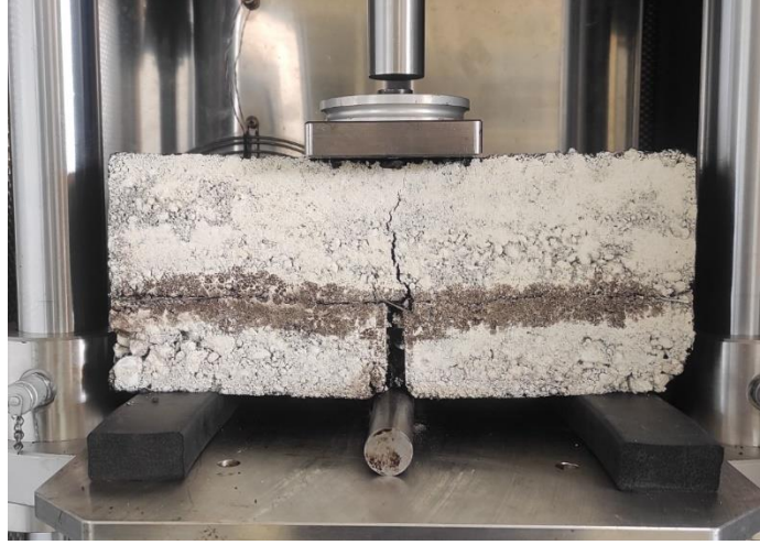
Ilustración 25: Viga B1 después del ensayo de carga cíclica
