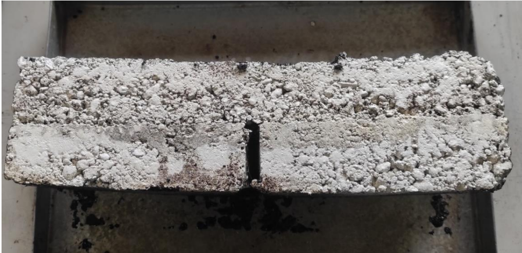
Ilustración 29: Deformación viga C1
