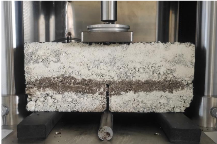
Ilustración 24: Viga B1 antes del ensayo de carga cíclica
