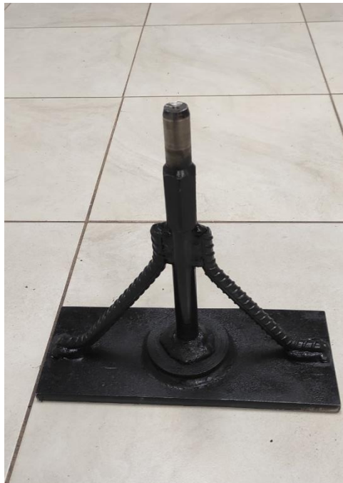
Ilustración 6: Pisón reforzado de acero para compactación de vigas (2do prototipo)
