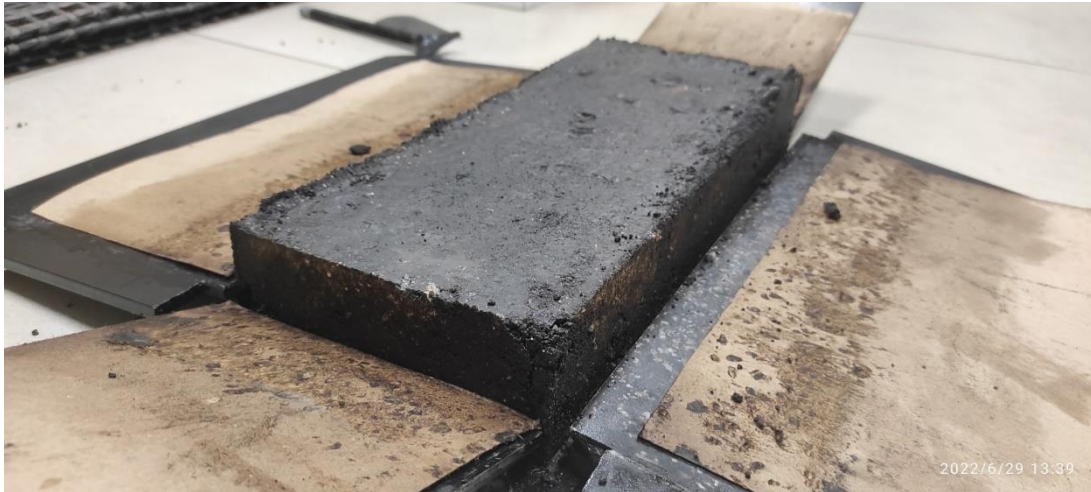
Ilustración 16: Capa antigua compactada de 6cm y desmoldada
