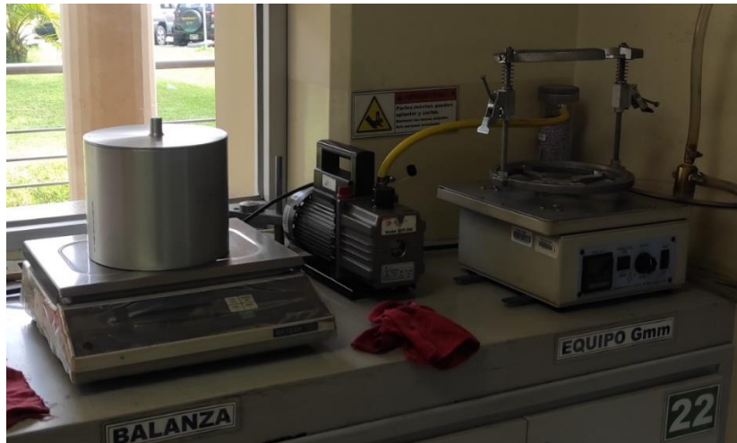
Ilustración 13: Ensayo de densidad máxima 2
