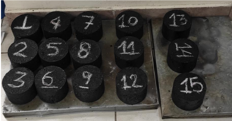
Ilustración 9: Briquetas de mezcla asfáltica antes de ensayo
