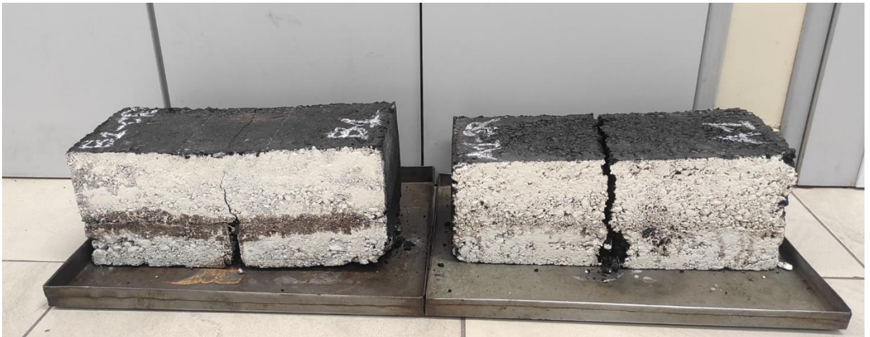
Ilustración 30: Comparativa de la falla en las vigas izq: B1 y A1
