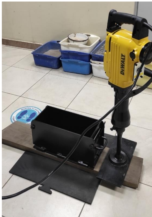
Ilustración 8: Equipo de compactación y molde
