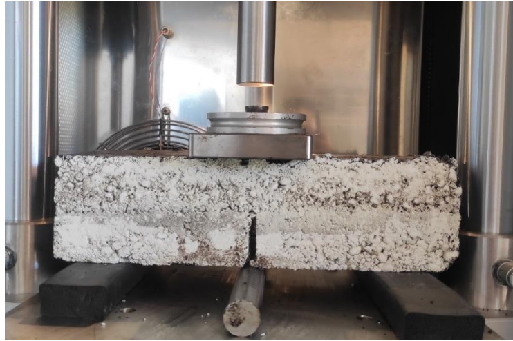
Ilustración 27: Viga C1 antes del ensayo de carga cíclica
