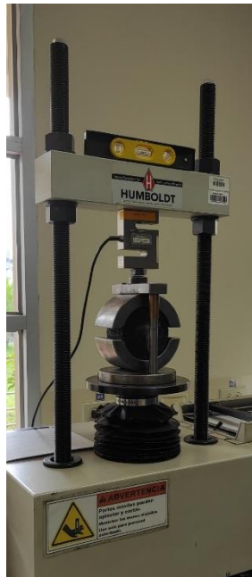
Ilustración 10: Ensayo de flujo y estabilidad
