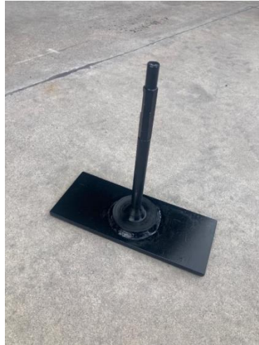
Ilustración 5: Pisón de acero para compactación de vigas (1er prototipo)
