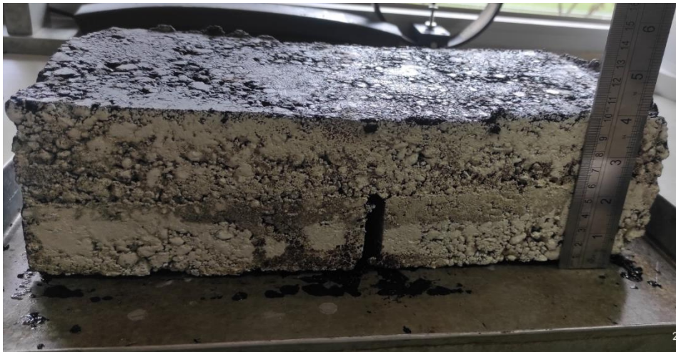
Ilustración 28: Viga C1 después del ensayo de carga cíclica
