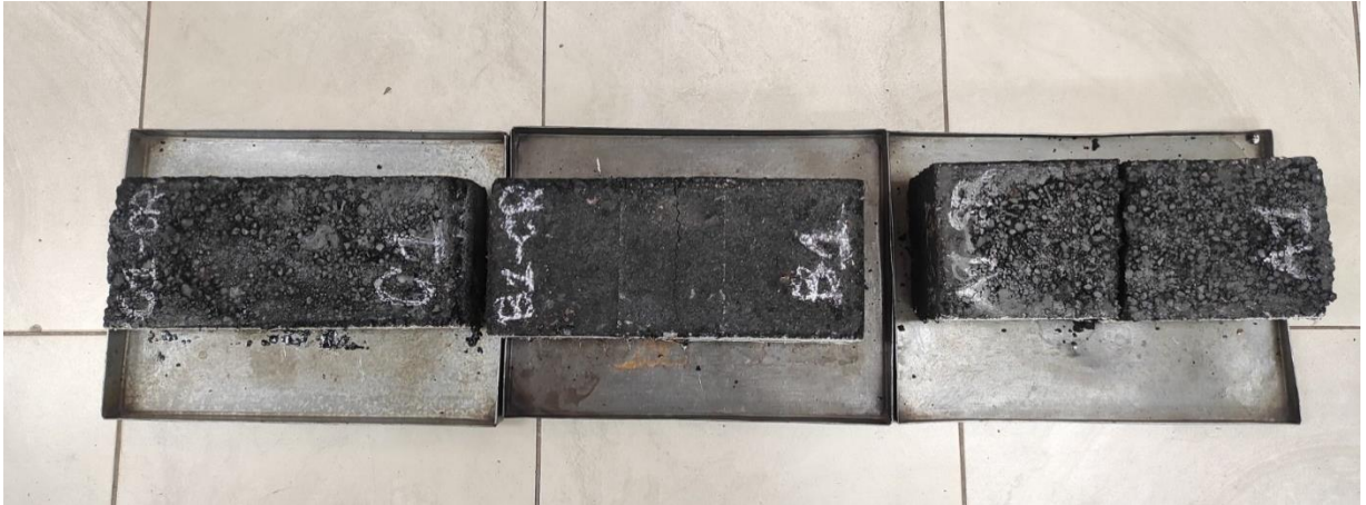
Ilustración 33: Comparativa 2 de la falla en las vigas izq: C1, B1 y A1
