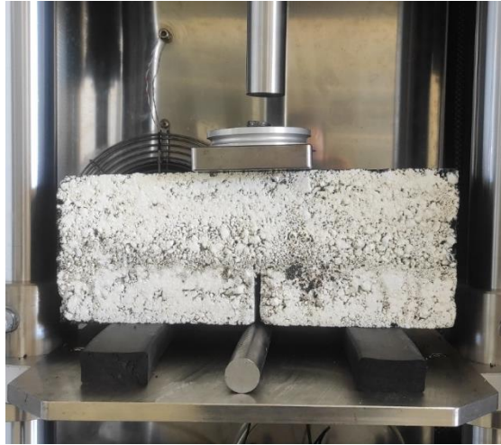
Ilustración 21: Viga A1 antes del ensayo de carga cíclica
