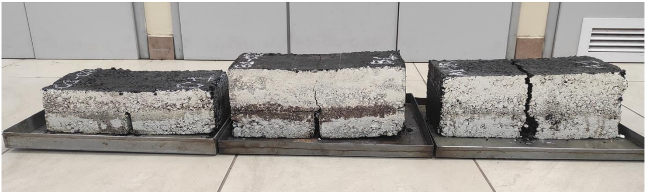
Ilustración 32: Comparativa de la falla en las vigas izq: C1, B1 y A1
