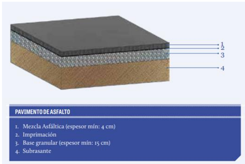
Ilustración 4.12: Pavimento Asfáltico Para Ciclovías
