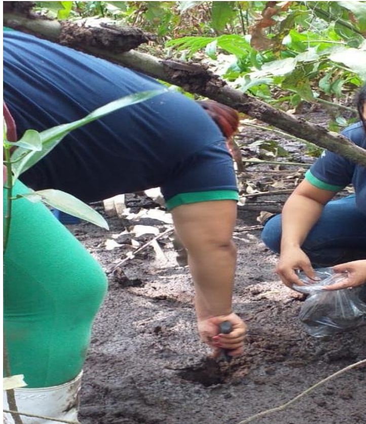
IMAGEN 4 TOMA DE MUESTRA DE SEDIMENTOS
