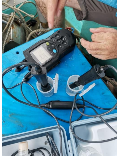
Fig. 3 Sonda multiparamétrica Hach 40 con muestras de agua midiendo los parámetros fisicoquímicos del agua in situ
