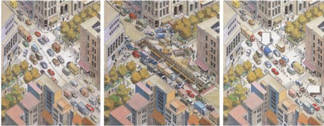
Figura 35. Rehabilitación de un tramo de tubería mediante apertura de zanja y CCTV
