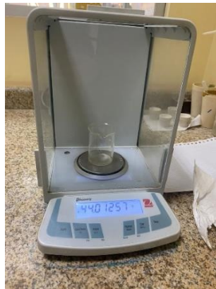
Ilustración 23. Peso de la muestra después del desarenador
