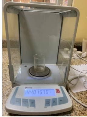
Ilustración 22. Peso de la muestra antes del desarenador
