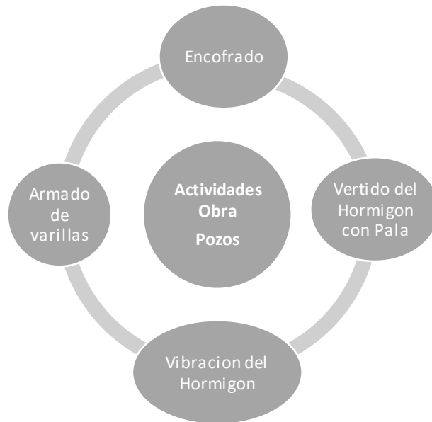
Figura 10 Actividades de obra que se realizan en Pozos.
