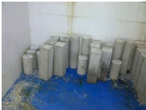
FOTO.- Cuarto de humedad para curado de muestras de hormigón.
