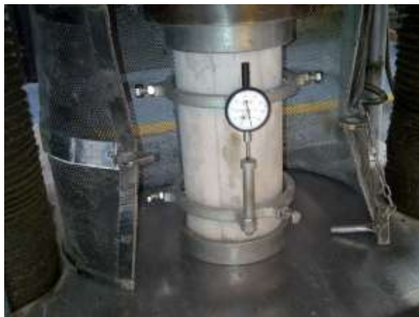
FOTO.-Cilindro ensayado a Compresión con módulo de Elasticidad.
