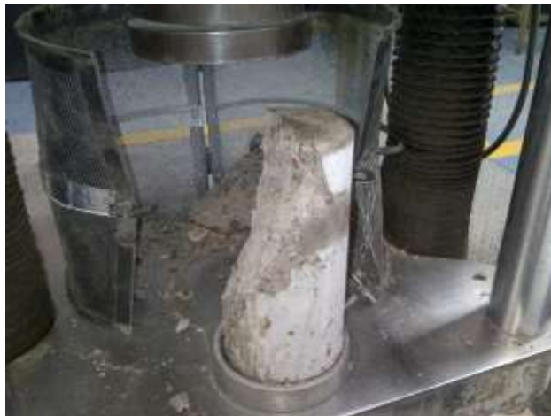
FOTO.- Cilindro Ensayado en Prensadora y con Jaula de Seguridad.
