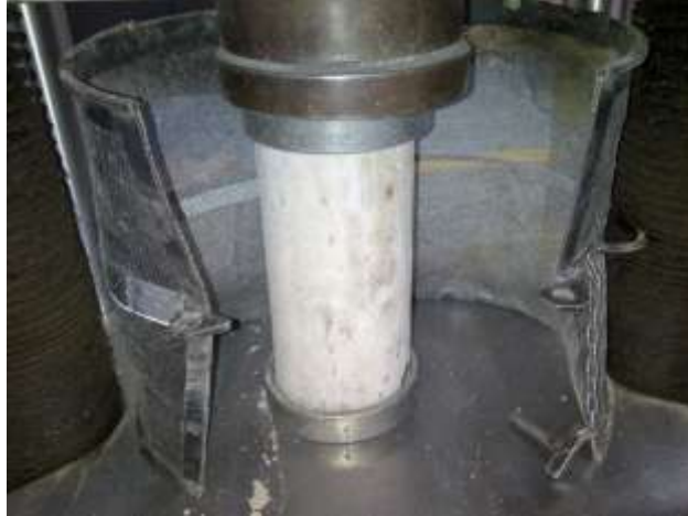
FOTO.-Cilindro ensayado a Compresión.
