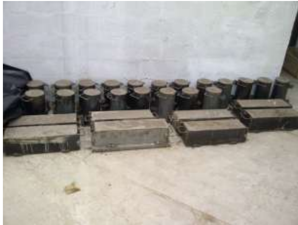
FOTO.- Toma de muestras para ensayos de compresión y flexión.
