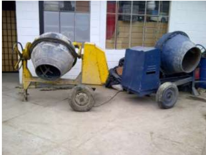
FOTO.- Mezcladoras utilizadas en la elaboración de los hormigones.
