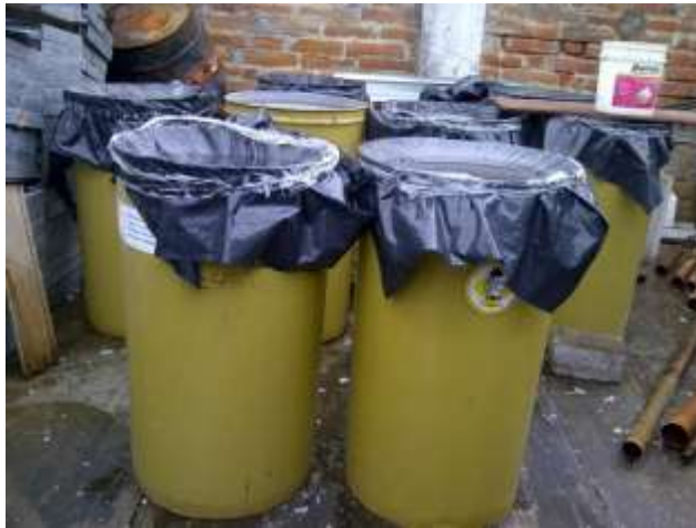
FOTO.-Tanques de curado con concentraciones de Sulfato de Sodio.
