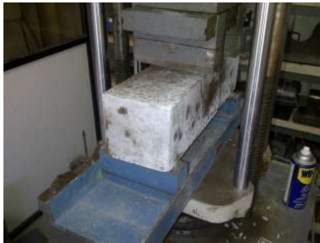
FOTO.-Viga sometida a Ensayo de Flexión.
